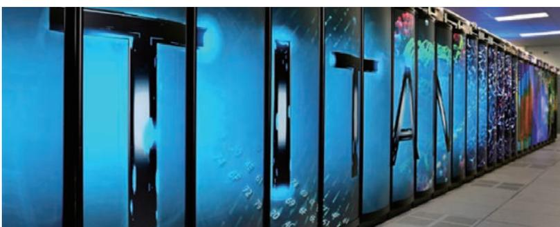
ORNLに設置されているスーパーコンピュータ『タイタン』。Cray XK7システムで、18,688ノードが含まれ、それぞれ16コアAMD Opteron 6274プロセッサとNVIDIA Tesla K20X GPUアクセラレーターで構築。710TBのメモリーも内蔵されている。
